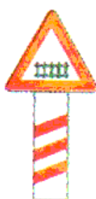
تقاطع جاده و راه آهن با راهبند نصب در ۳۰۰ متری
